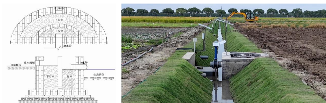
图 4 田块排水阻控 DSI-RIS-III 工艺构筑设计及实景
