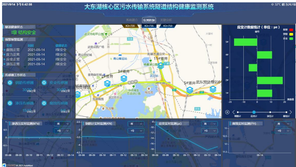
图 9 深隧结构健康监测系统
