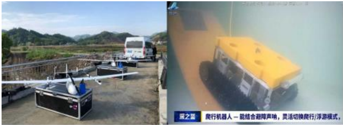
图 6-12 长江排污口排查中无人机（左）和水下机器人（右）的应用
