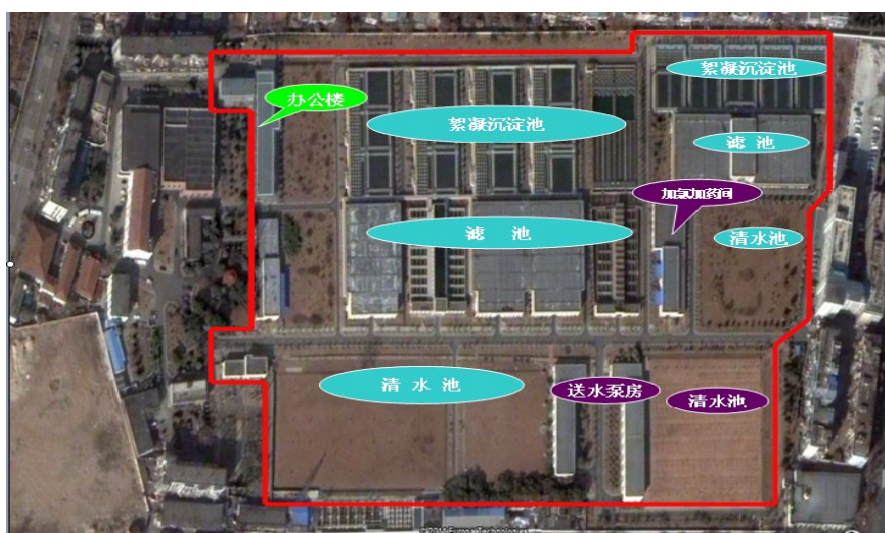
图 3-3 武汉水务集团所属宗关水厂工艺流程和全图
