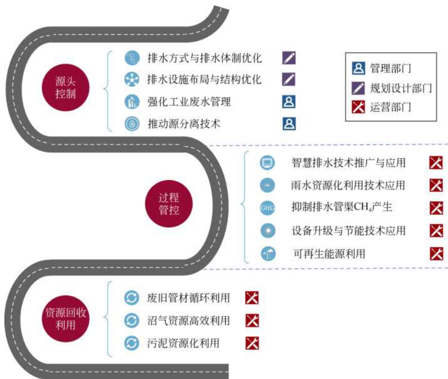
图 8-8 城市排水管网系统碳减排路线图
