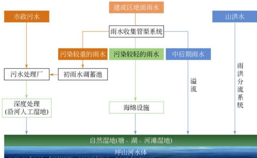
图 3-8 截流初期雨水的完全分流制排水体制示意图
